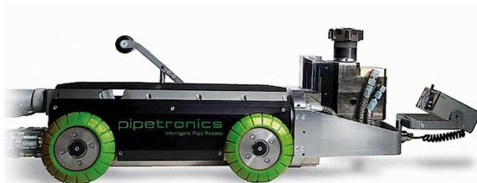
In DIRINGER & SCHEIDEL steckte schon früh ganz viel Technik – und heute sogar Robotik! Dabei dreht sich alles um die grabenlose Sanierung von Rohrleitungssystemen mittels innovativer Verfahren, eine Alternative
